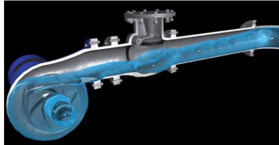
(1) Inicio paro de la bomba
