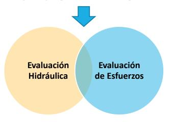
INICIALMENTE el foco de atención debe centrarse en determinar (y controlar si es necesario) las sobrepresiones y depresiones transitorias que resultan del golpe de ariete. Para ello el esfuerzo de ingeniería debe concentrarse en dos conceptos:
